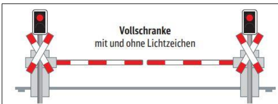
Abbildung 2-7: Sicherung mit Lichtzeichen und Vollabschluss [DB18]
