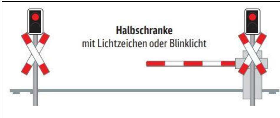
Abbildung 2-6: Sicherung mit Lichtzeichen und Halbschranken [DB18]
