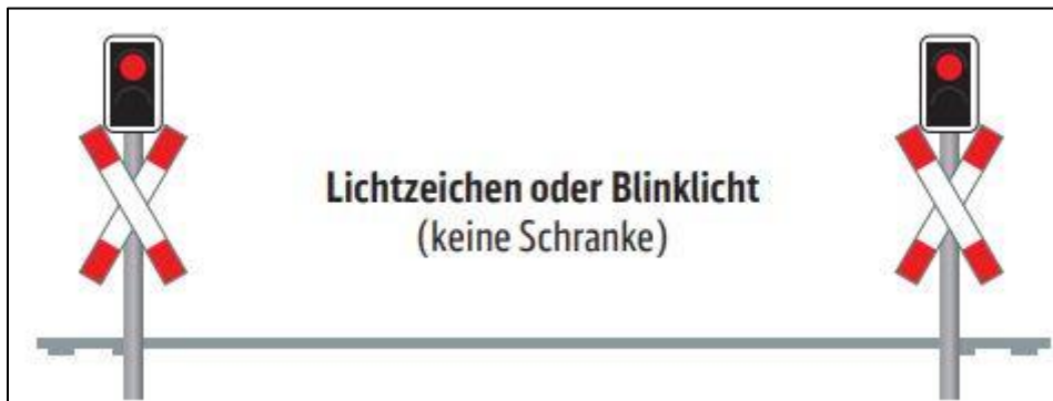
Abbildung 2-5: Sicherung mit Lichtzeichen ohne Schranken [DB18]
